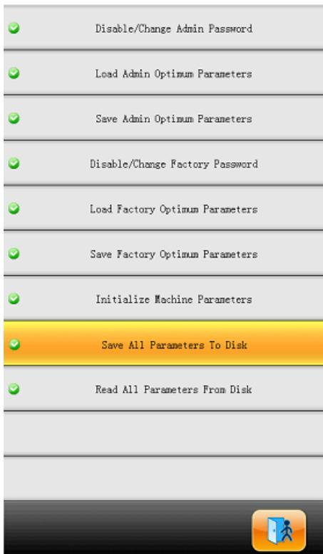
4) При выводе сообщения "Insert Disk To Save All Parameters", установите USB диск и затем
