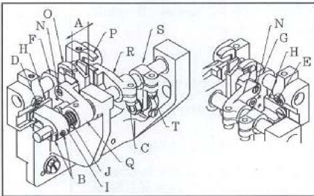
Установите нижние ножи L в крепления F и G. Отрегулируйте высоту ножей, после чего затяните фиксирующие гайки K.
