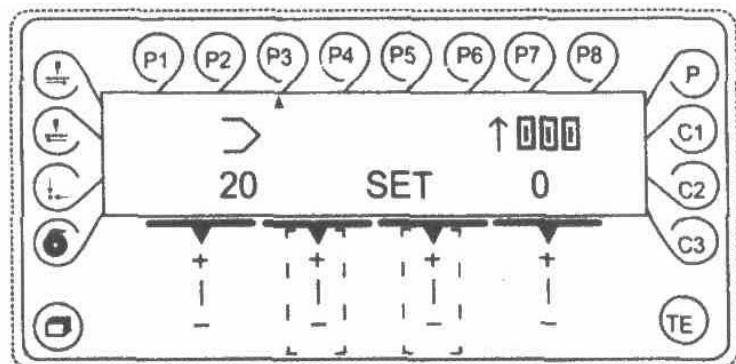
Счетчик количества заготовок начинает отсчет от 0 и отличается от счетчика шпульной нити на дисплее значком в виде стрелки, направленной вверх.
