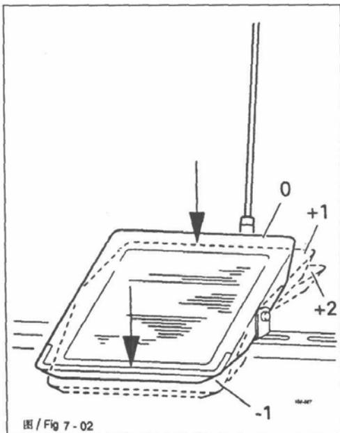
Педаль используется для опускания и подъема устройства зажима заготовки и начала программы шитья.
