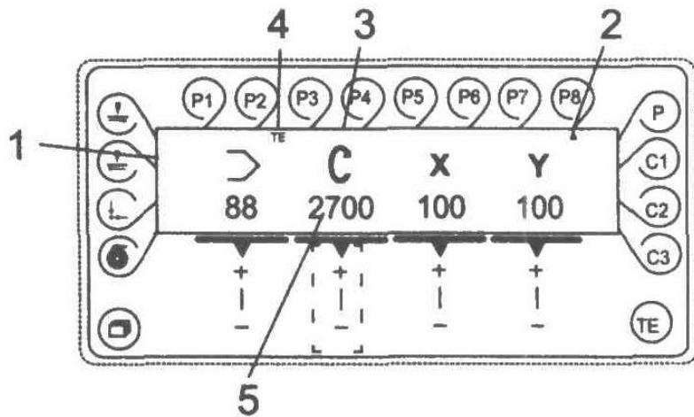
Панель управления состоит из экрана дисплея 1 и ряда функциональных клавиш.
