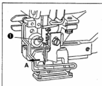
Удерживайте иглу так, чтобы ее желобок находился прямо со стороны оператора А, вставьте иглу в отверстие игловодителя до упора, и затяните установочный винт иглы ④. Используйте иглу типа DPx5-(#11 J, #14J).
