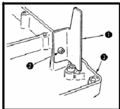
Установите предохранительную пластину 1 на поддон машины 3 с помощью установочного винта 2.
