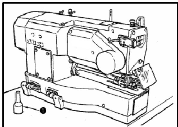
Во время откидывания головки машины, медленно откидывайте головку машины до тех пор, пока она не будет соприкасаться с опорным штифтом головки машины 1.
