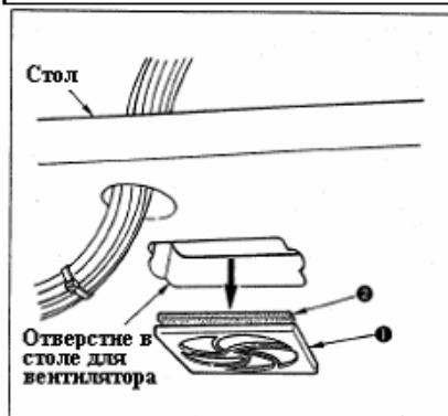
Производите чистку фильтра { вентилятора, который находится на нижней части стола швейной машины раз в неделю.
