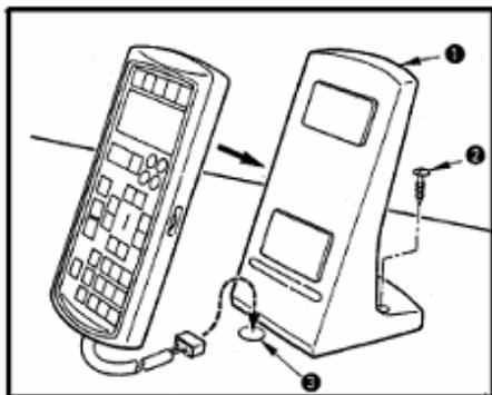
Закрепите подставку 1 для панели управления, на столе, с помощью винта 2, и протяните кабель через отверстие 3 в столе.
