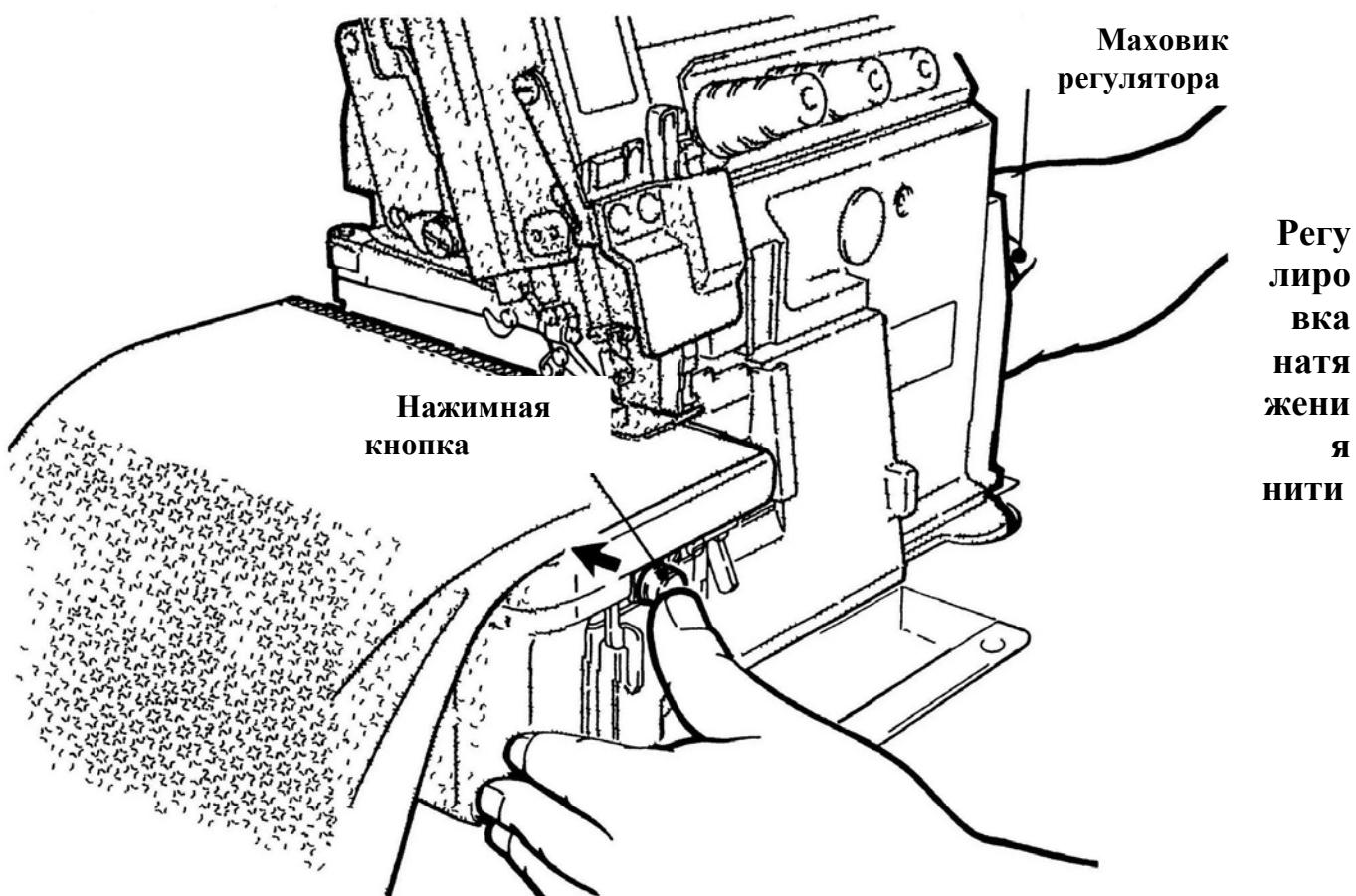
Регулировка натяжения нити производится при помощи ручки регулятора натяжения игольной нити (1), ручки верхнего петлителя (2) и ручки нижнего петлителя (3).
