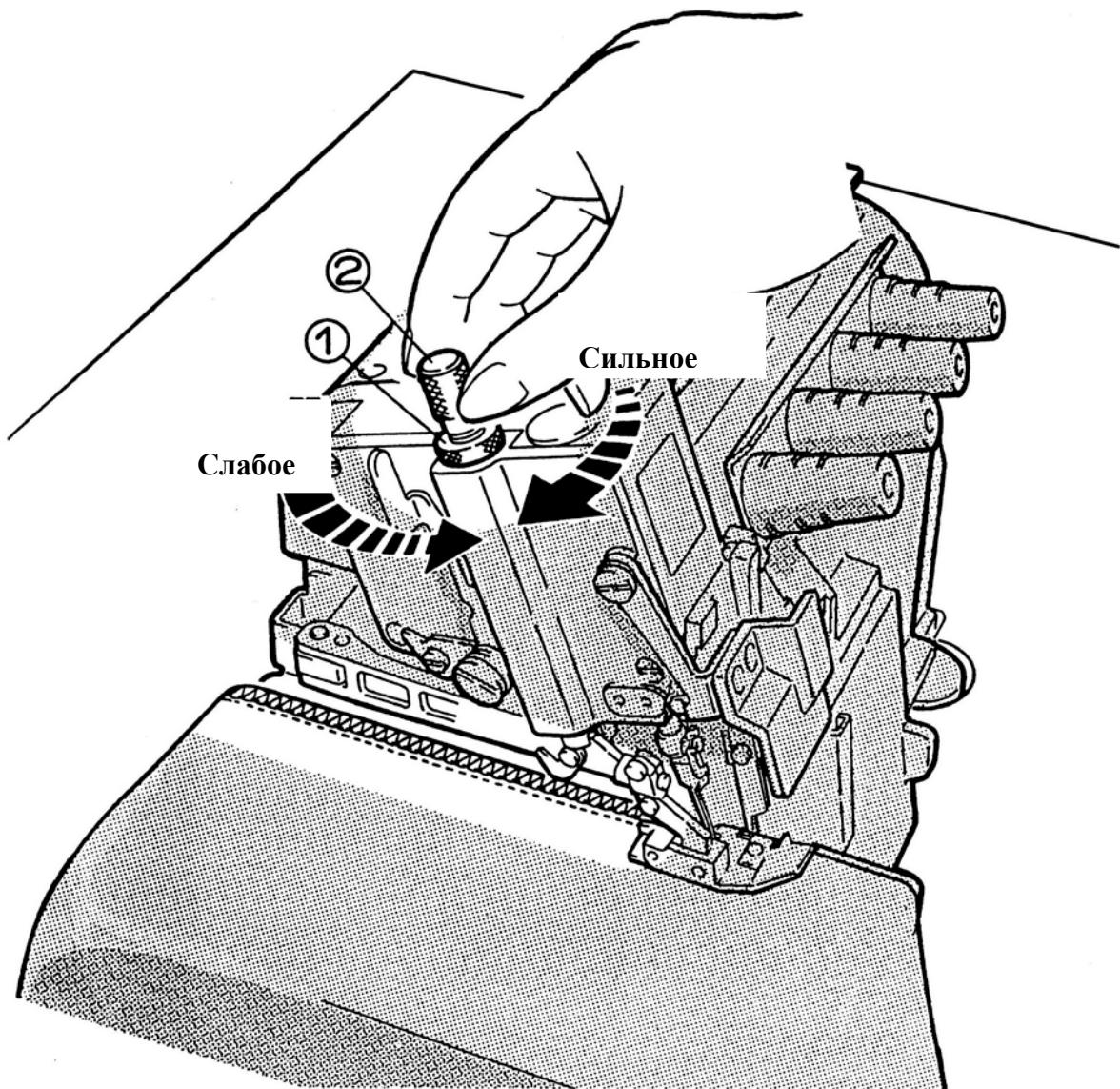
Регулировка дифференциальной подачи и ткани
