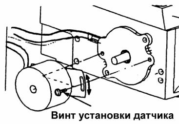
23) Винт крепления датчика
