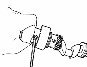
9) Винт крепления и втулка винтовой зубчатой передачи
