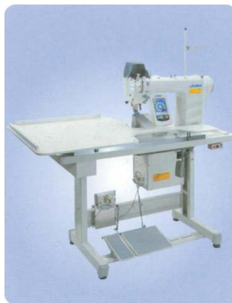
\*<sup>1</sup> Максимальная скорость шитья ограничивается величиной попеременного вертикального передвижения шагающей прижимной лапки и прижимной лапки и длины стежка.
